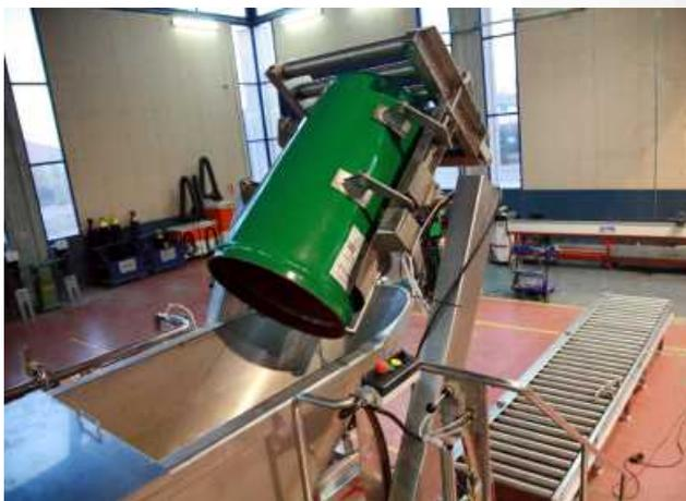
La rampe de décharge alimente un dépôt qui contient un agitateur-tritrateur qui rompt le produit en petits morceaux.
